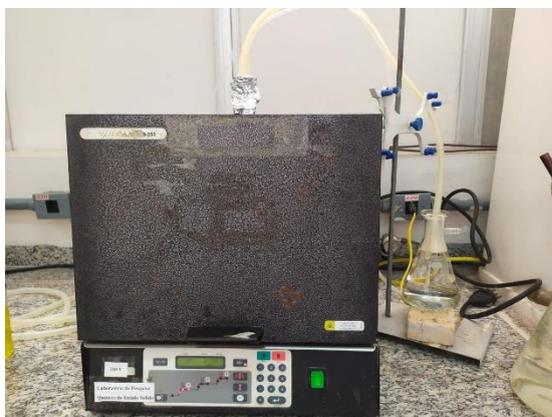
**Figura 6** – Mufla utilizada na preparação dos catalisadores. (Fonte: Autor, 2024)
