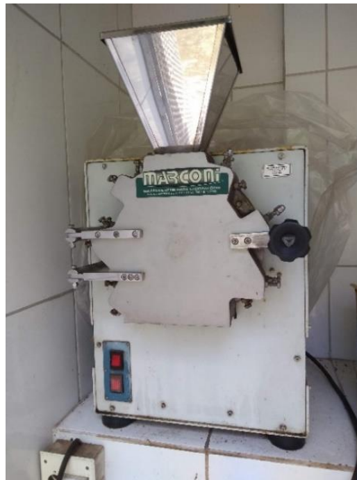
Figura 10 - Moinho de facas utilizado no processamento da fibra de coco seco.
