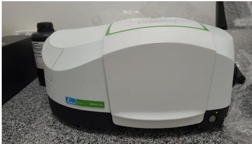
Figura 17 - Equipamento utilizado nas análises de FTIR.
