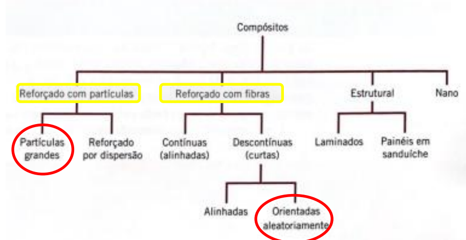
Figura 4 - Esquema de classificação para os vários tipos de compósitos.
