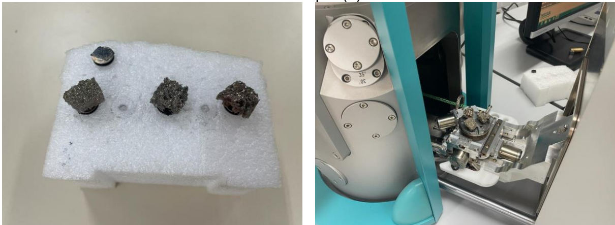
Figura 16 - Imagens das amostras metalizadas (a) e sendo acopladas ao microscópio (b).
