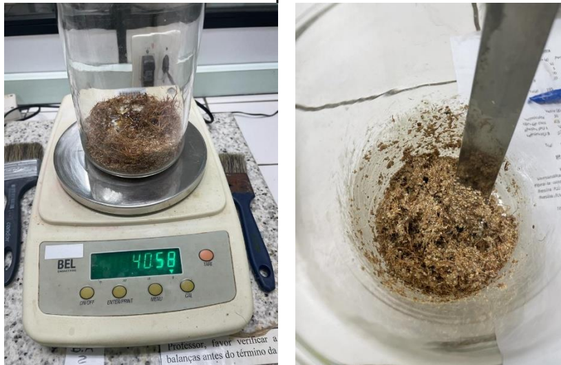
Figura 12 - Pesagem dos materiais (a) e mistura com espátula (b) para obter o compósito.
