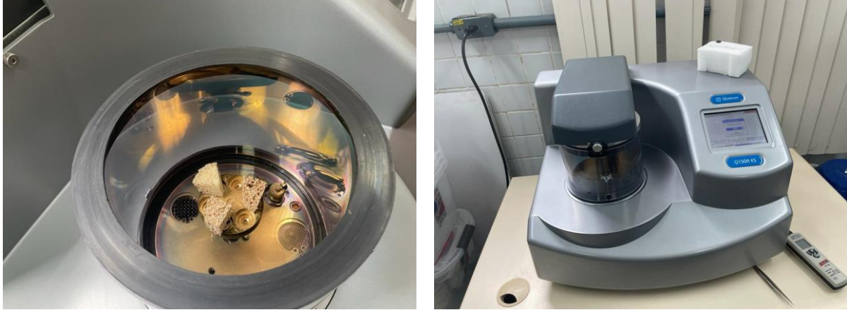
Figura 15 - Imagens da etapa de metalização da amostra (a), efetuada antes dos experimentos de MEV, e do metalizador empregado (b).
