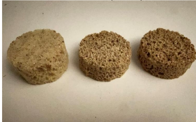
Figura 14 - Amostras dos compósitos após secagem e retirada do molde: V10F5, V20F10 e V26F13, da esquerda para a direita.
