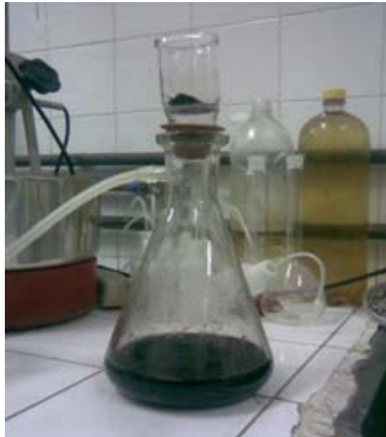
Figura 4.9 – Ensaio para a determinação do teor de lignina.
