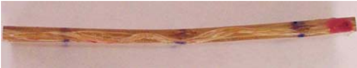
Figura 5.25 – Curvatura sofrida pelo corpo de prova no ensaio de flexão em três pontos.
