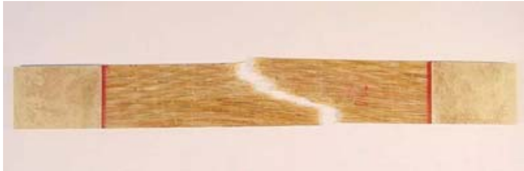
Figura 5.16 – Corpo de prova fraturado na tração uniaxial longitudinal.
