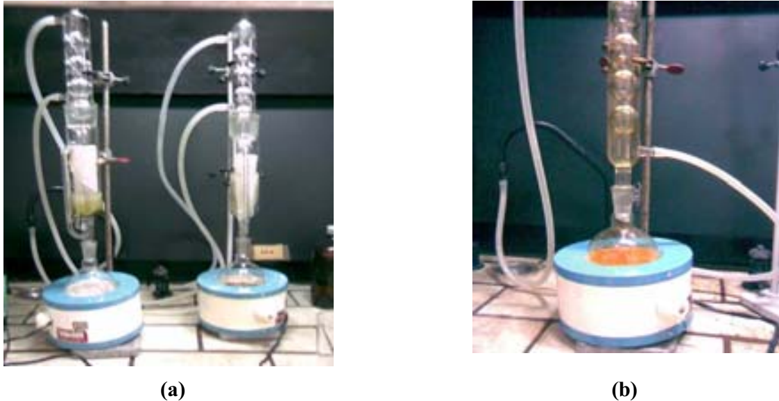
Figura 4.6 (a) e (b) – Ensaio para a determinação do teor de extrativos.
