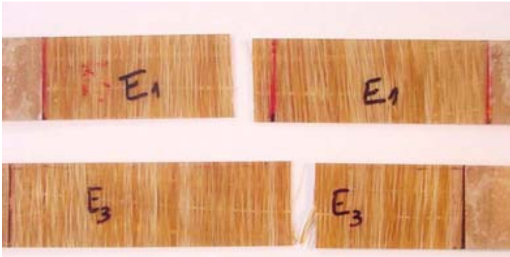
Figura 5.20 – Fratura plana obtida nos ensaios de tração uniaxial transversal.
