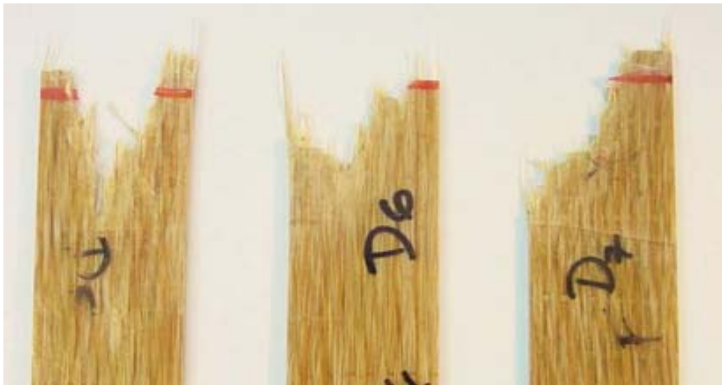
Figura 5.17 – Diferentes características da fratura final – Tração uniaxial longitudinal.
