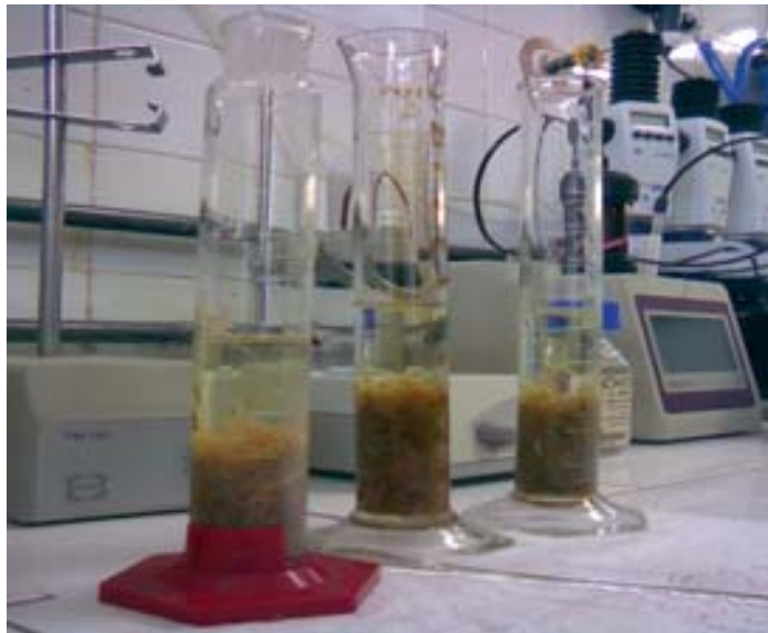
Figura 4.3 – Ensaio para a determinação da densidade volumétrica.
