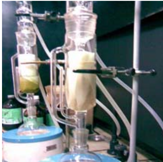
Figura 4.8 – Ensaio para a determinação do teor de cera.
