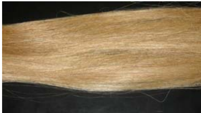
Figura 1.12 – Fibras de Curauá prontas para impregnação em plástico reforçado. Fonte: Banco de dados da BPMCC – DEM/UFRN, 2008.
