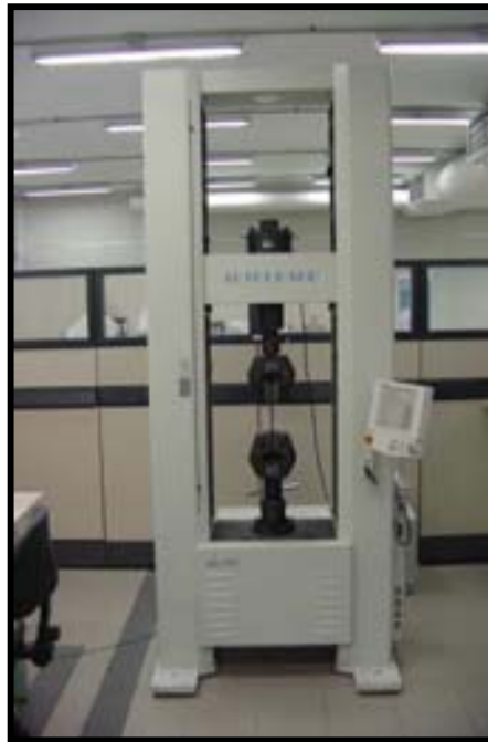
Figura 4.14 – Máquina para os ensaios de tração uniaxial e flexão em quatro pontos.
