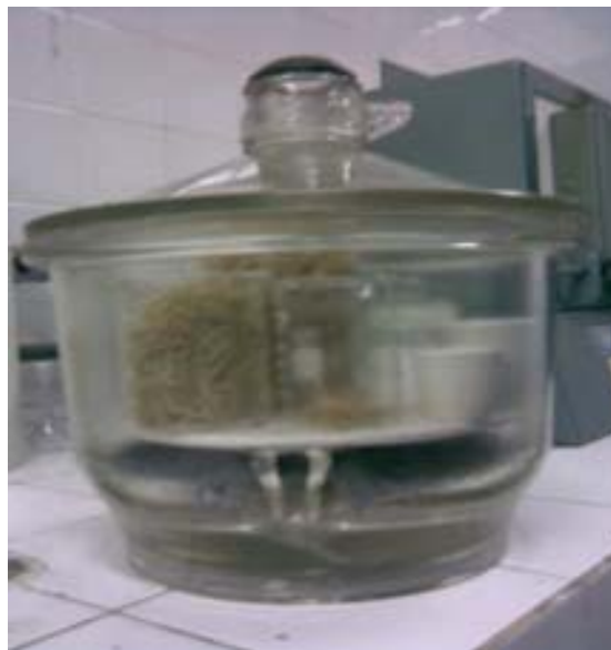
Figura 4.4 – Ensaio para a determinação do teor de umidade.
