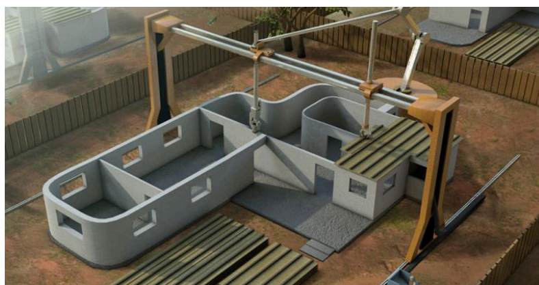
Figura: 3- Técnica de impressão Contour Crafting
