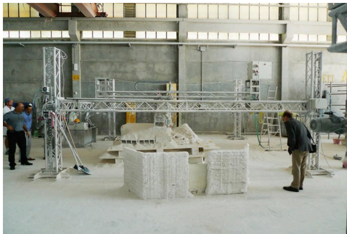
Figura : 6 - Impressão com D-shape
