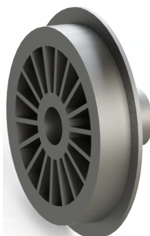
Figura 16 – Secção do carretel modificado
