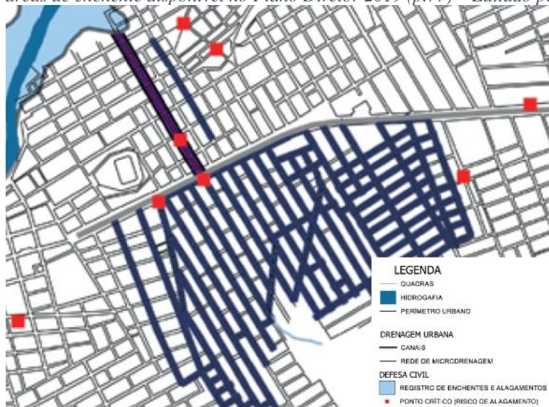
Figura 62 – Recorte do mapa da rede existente de drenagem, pontos de alagamento e áreas de enchente disponível no Plano Diretor 2019 (p.77) – Editado pelo autor
