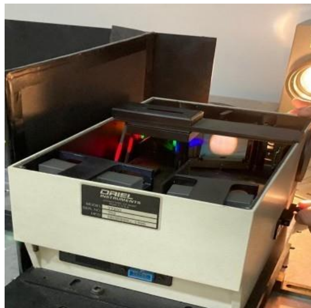
Figura 16: Monocromador determinação do comprimento de onda Sistema de medida de corrente por tensão do CELSOL.
