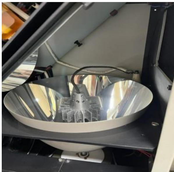
Figura 12: Lâmpada do sistema de caracterização de curva IxV de células solares de silício do CELSOL.
