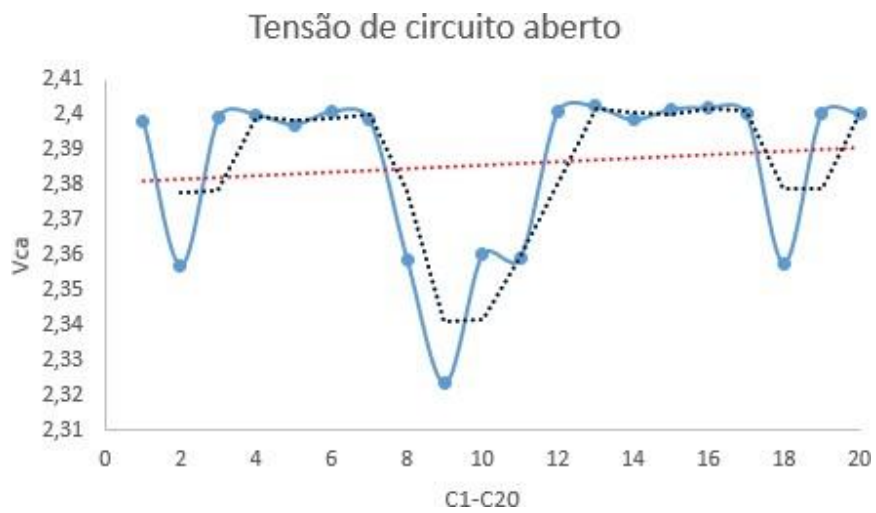
Figura 20: Tensão de circuito aberto com linha de tendência e média móvel entre as placas.
