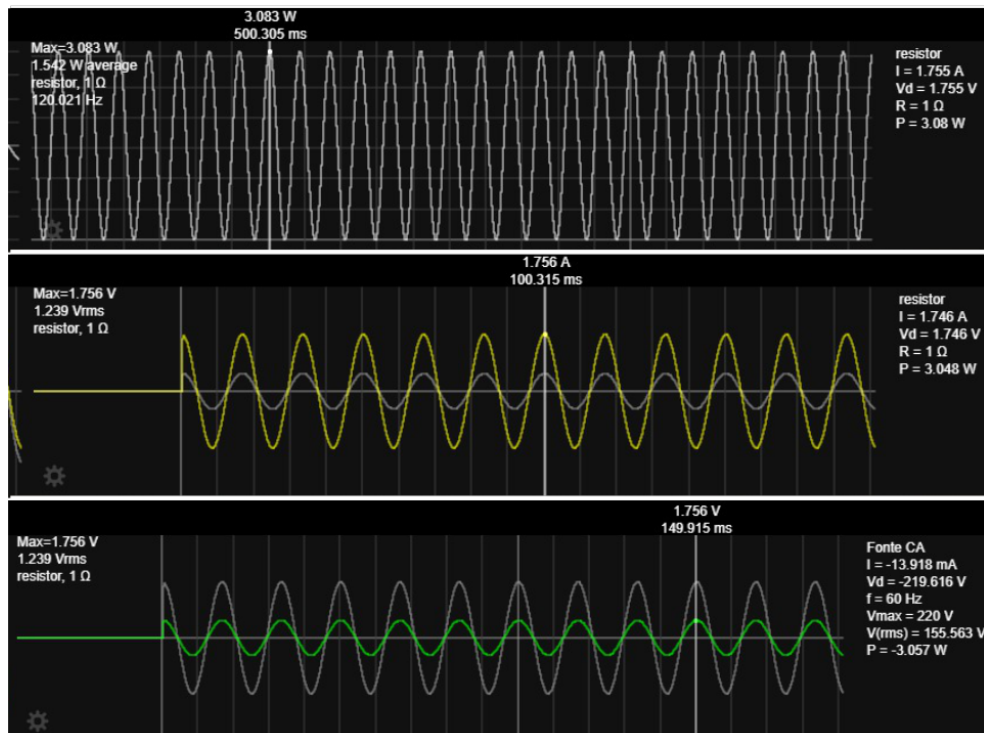
Figura 22 – Simulação de um transformador redutor com razão 125.
