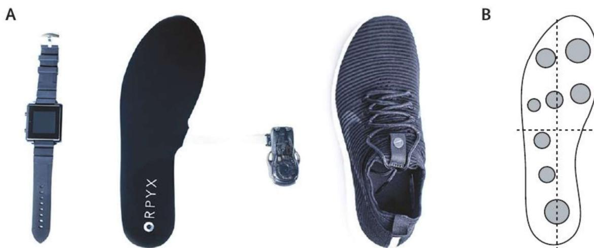
Figura 22 - (A) Sistema de palmilha inteligente acompanhado de smartwatch. (B) Regiões dos sensores de pressão. Fonte: Abbott *et al.*, 2019.
