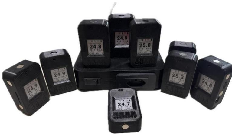
*Figura 62 - Conjunto de sensores e hub para qualificação térmica automatizada*
