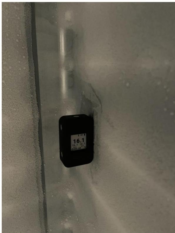
*Figura 67 - Sensor grudado na parede pelos imãs cravados no gabinete plástico (Fonte: o autor)*
