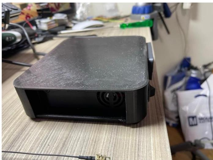
*Figura 46 - Impressão 3D do hub concentrador (Fonte: o autor)*
