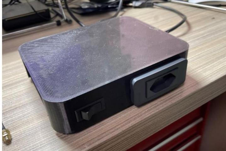
Figura 47 - Impressão 3D do hub concentrador vista frontal (Fonte: o autor)
