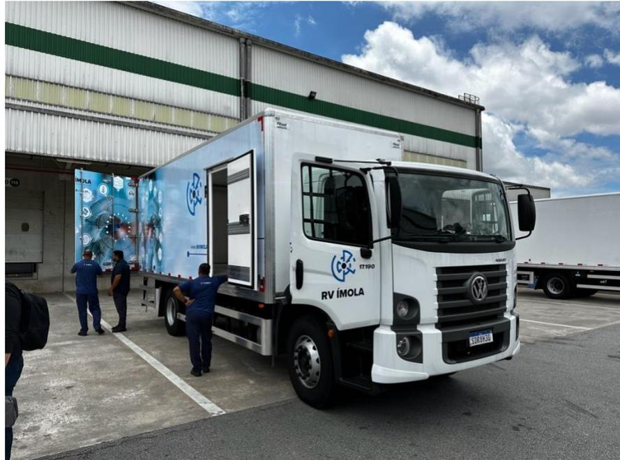
*Figura 63 - Caminhão refrigerado para transporte de termolábeis (Fonte: o autor)*
