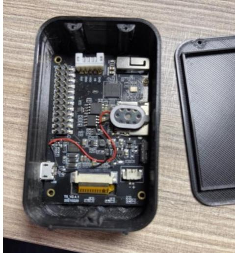
*Figura 54 - Componentes internos do sensor portátil (Fonte: o autor)*
