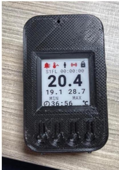
*Figura 53- Sensor portátil montado (Fonte: o autor)*
