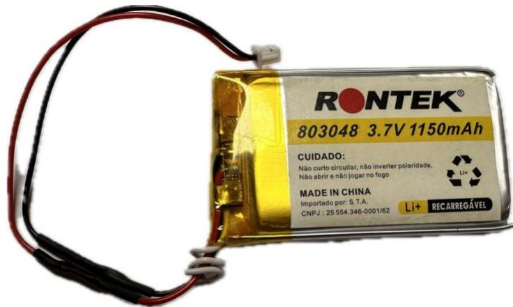
Figura 23 - Bateria da Rontek de 1150 mAh (Fonte: o autor)
