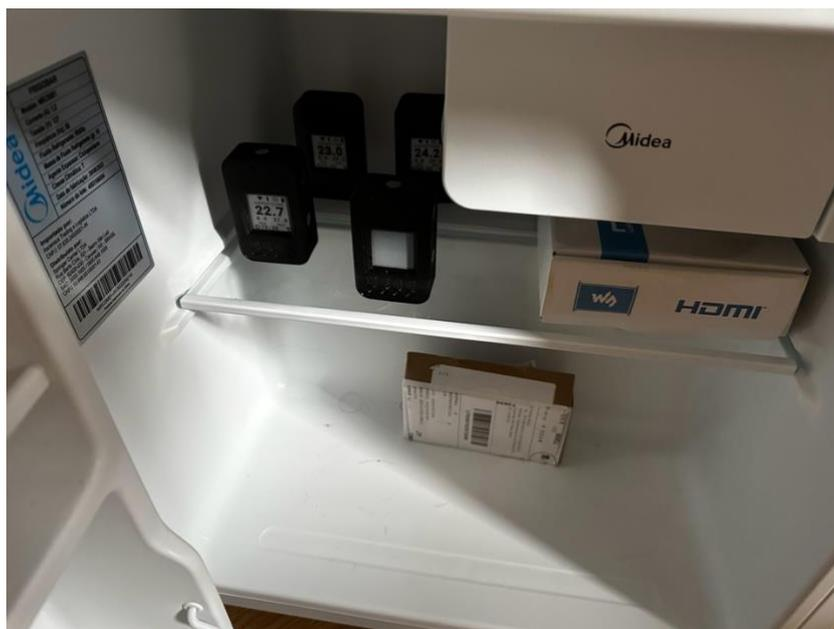
Figura 58 - Refrigerador frigobar em teste pelo sistema desenvolvido (Fonte: o autor)
