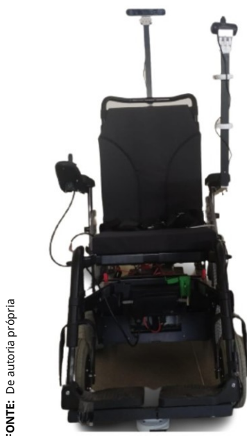
Figura 3.2 – Cadeira motorizada modificada para navegação autônoma
