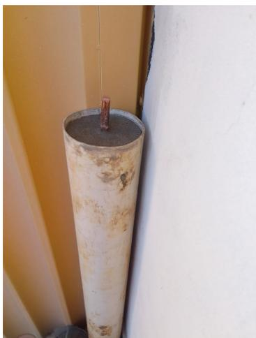
**Figura 3.7** – Confecção da haste concretada em molde de PVC.
