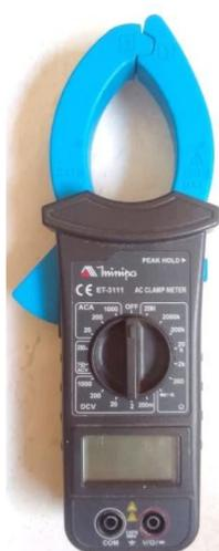
**Figura 3.11** – Alicate amperímetro.
