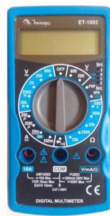
**Figura 3.12** – Multímetro.
