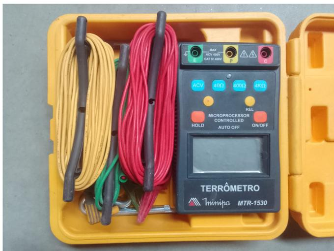
**Figura 3.15** – Terrômetro utilizado para medição da resistência de aterramento.
