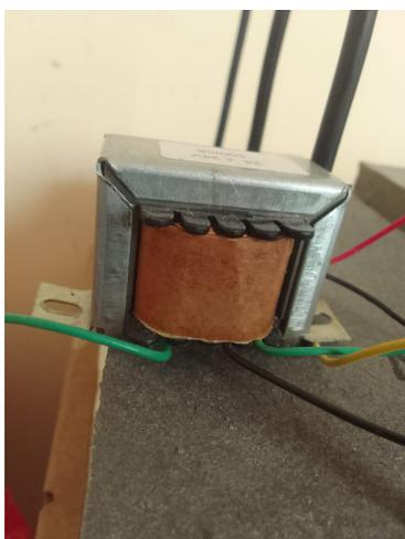
**Figura 3.10** – Transformador de 220/(24+24) V, 250 mA e 24 W
