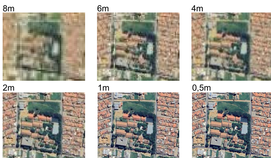
Figura 2.7 – Espaço geográfico do IFBA campus Vitória da Conquista sendo ilustrado por 6 resoluções espaciais
