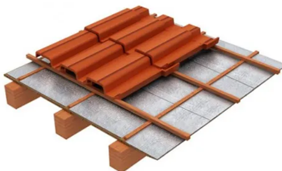
Figura 6 – Instalação da manta termoacústica no telhado
