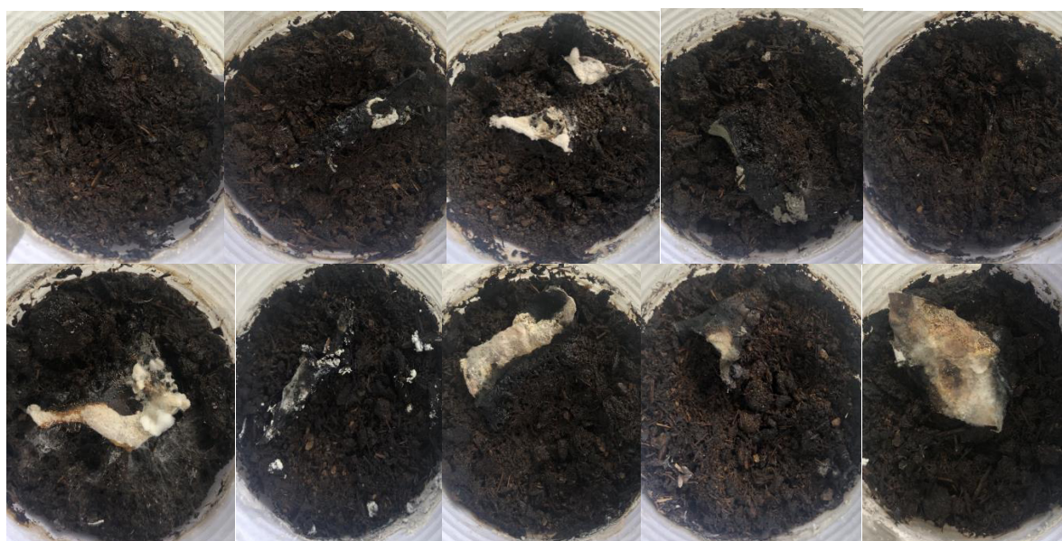
Figura 5.23 – Etapa de degradação dos filmes que ficaram sobre o solo por 60 dias: M3G30, M4G30, M3S30, M4S30, M3S20G10, M4S20G10, M3S15G15, M4S15G15, M3S10G20, M4S10G20
