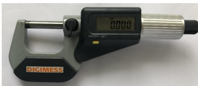
Figura 4.2 – Micrometro digital usado na análise da espessura
