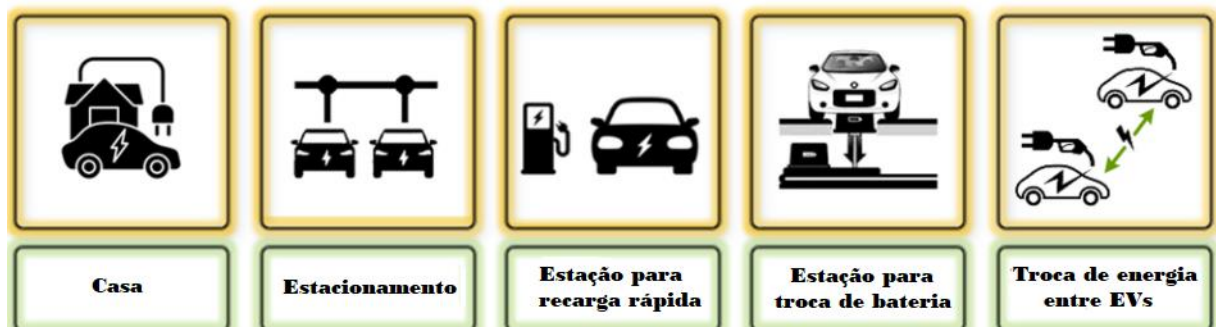
Figura 7 - Diferentes métodos utilizados para recarga de um EV
