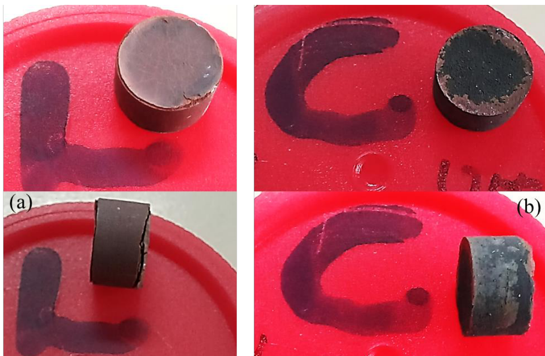
Figura 5.10 – Amostras compactadas a 947 MPa após sinterização a 1200°C por 1 h: (a) FL5T – oxidada e com fratura e (b) FC5T – com pontos de oxidação.
