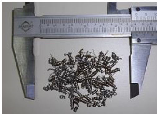
Figura 4.3 - Cavaco de aço SAE 1045 oriundo de torneamento a seco.
