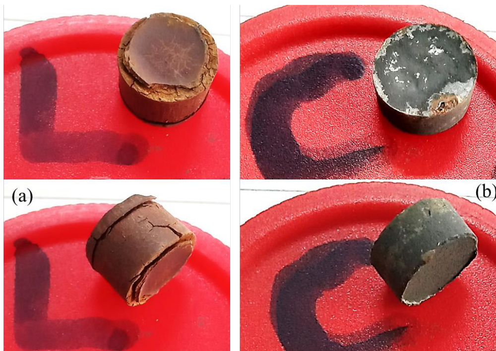
Figura 5.12 – Amostras compactadas a 1325 MPa após sinterização a 1200°C por 1 h: (a) FL7T – excessivas fraturas e delaminação e (b) FC7T – ponto severo de oxidação.
