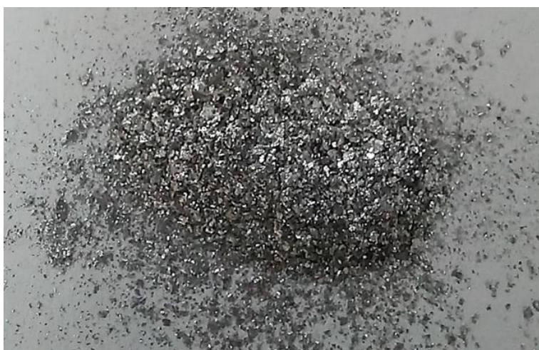
Figura 5.1 – Latas de alumínio após 4 h de moagem.
