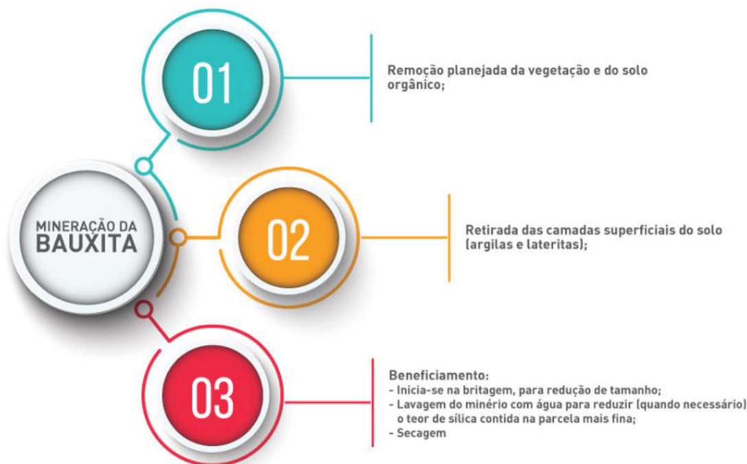
Figura 3.1 – Processo de mineração da bauxita (Fonte: ABAL, 2023).
