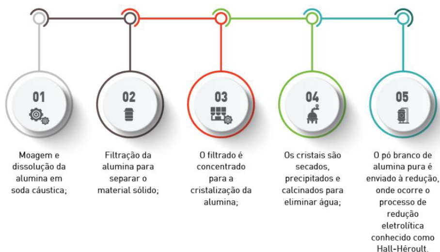
Figura 3.2 – Processo Bayer de refino da alumina (Fonte: ABAL, 2023).
