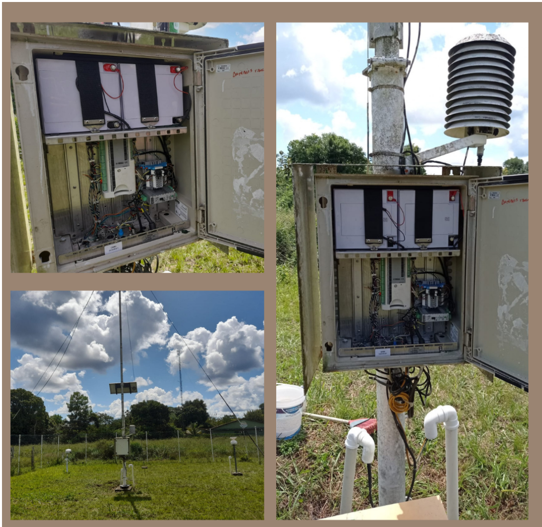
Figura 7 – Estação de observação de dados meteorológicos automáticas do INMET localizada na cidade de Porto Seguro - BA
