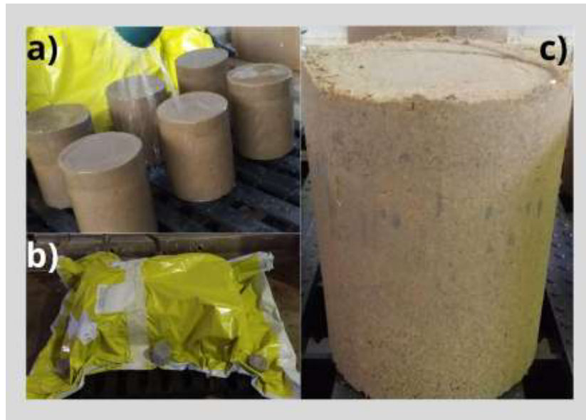
Figura 3.14 - Processo de cura dos corpos de prova: a) regagem, b) cobertura com plástico e c) corpo de prova curado.
