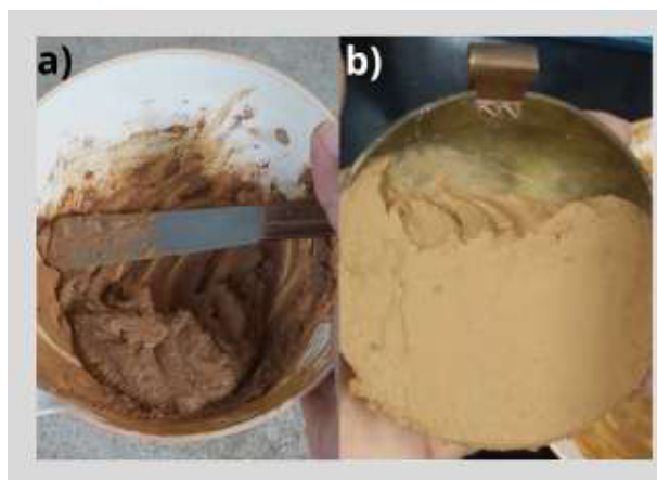
Figura 3.9 - a) Pasta obtida pela homogeneização do solo com água destilada; e b) pasta de solo cobrindo a concha do aparelho Casagrande.
