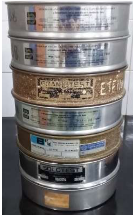
Figura 3.7 - Arranjo das peneiras utilizadas no ensaio de granulometria.
