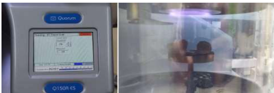
Figura 3.20 - Recobrimento das amostras de solo-cimento para o MEV.
