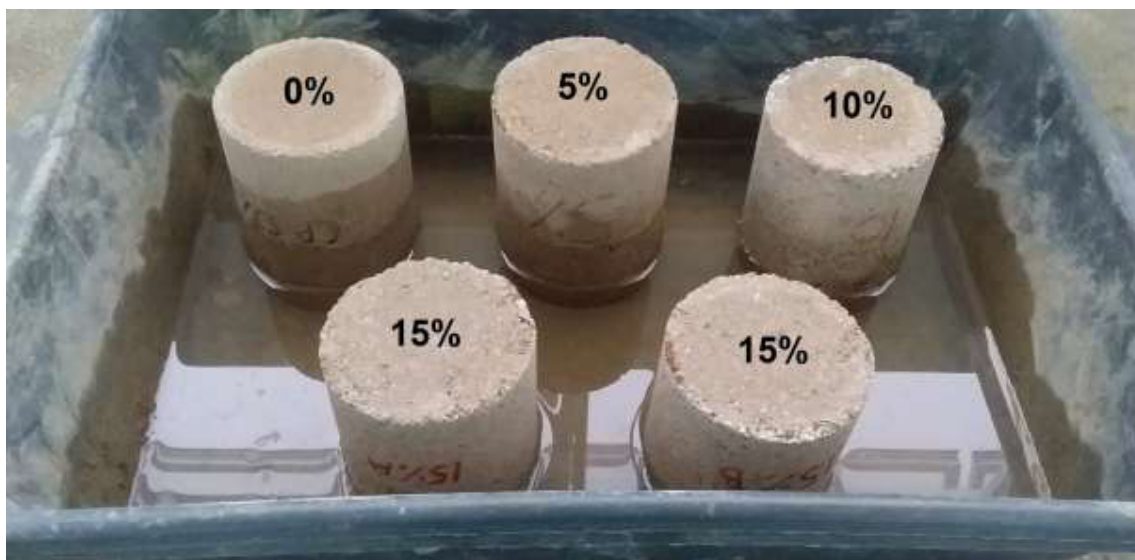
Figura 4.21 - Efeito da capilaridade em corpos de prova com diferentes percentuais de resíduos.
