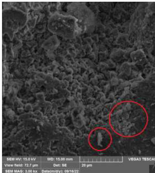
Figura 4.8 - Gel de C-S-H sobre matriz de argila, circulado de vermelho.
