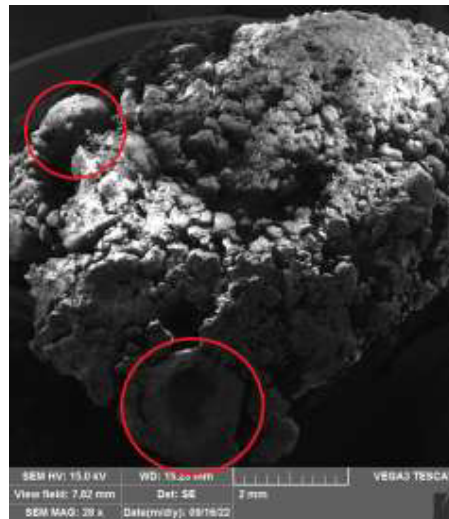
Figura 4.10 - Resíduos de alumina incrustados em matriz de solo-cimento.
