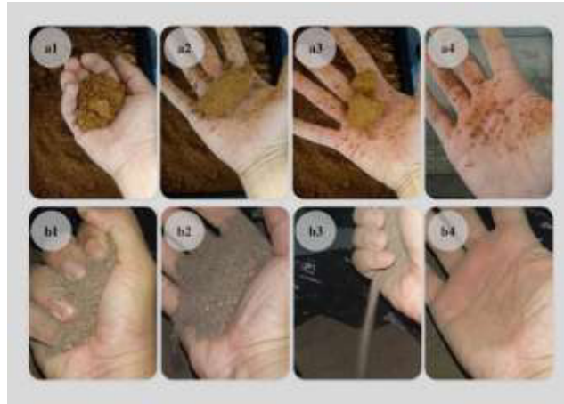
Figura 3.2 - Exame táctil dos solos: a1-a4) argiloso e b1-b4) arenoso.
