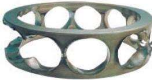
Figura 8 – Falha por fratura.
