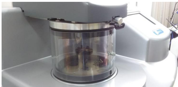
Figura 12 - Partes seccionadas da superfície de fratura sendo metalizadas
