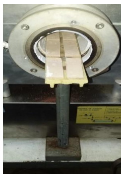
Figura 10: Amostras sendo colocadas no forno tubular
