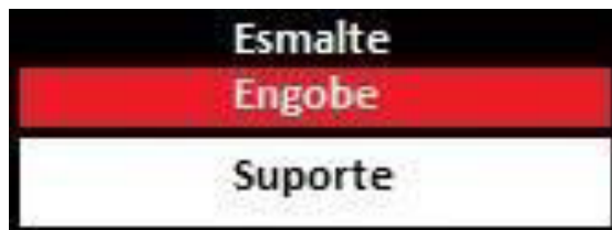
Figura 1 - Ilustração das camadas do revestimento cerâmico
