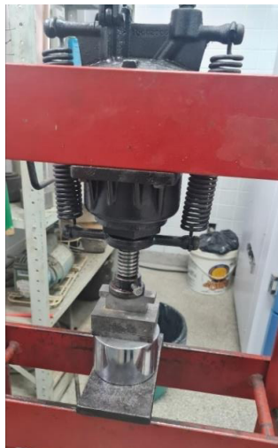
Figura 9 – Etapa de compactação dos corpos de prova
