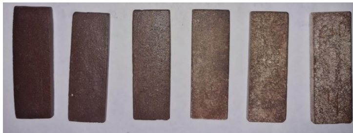
Figura 13 - Da esquerda para a direita, os corpos de prova com 0, 2, 4, 6, 8 e 10% de resíduo incorporado na massa padrão
