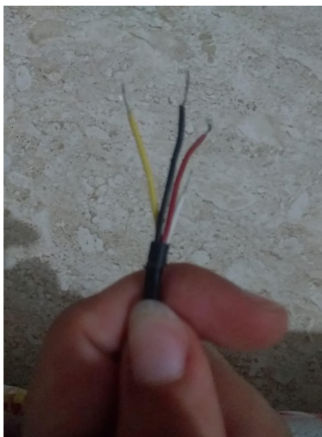
FIGURA 36- Fios desencapados do cooler
