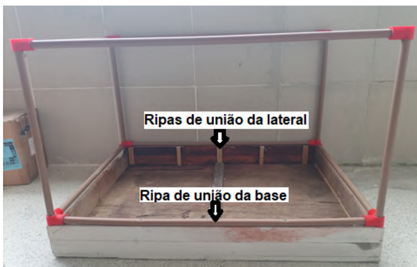
FIGURA 46- Estrutura principal da estufa
