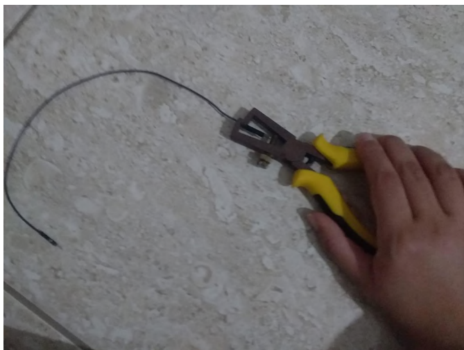
FIGURA 35- Processo de desencapar os fios
