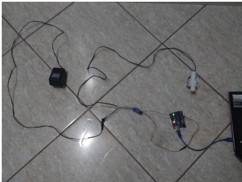
FIGURA 34-Teste da válvula solenóide: circuito completo
