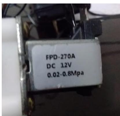
FIGURA 20- Especificações da válvula solenóide
