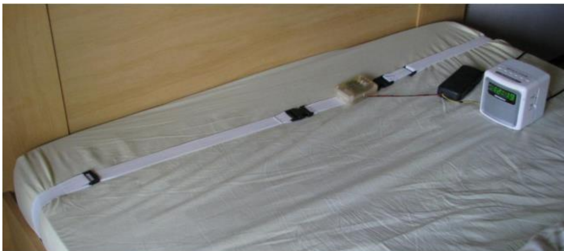
Figura 5: Protótipo de despertador para surdos.
