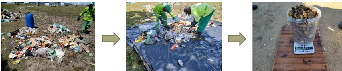
Figura 5 – Técnica do quarteamento – 2ª Parte.
