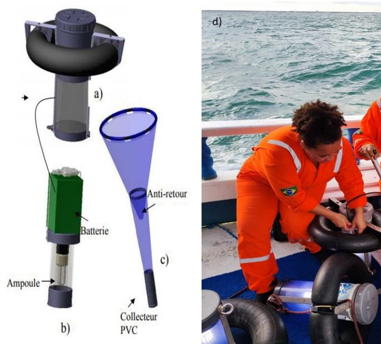
Figura 6. Desenho esquemático de uma armadilha luminosa do tipo CARE®: a) sistema flutuante impermeável (que permite que a armadilha fique na superfície da água), b) sistema de iluminação (18 horas de duração da luz, bateria recarregável de chumbo selada 12V / 12,
