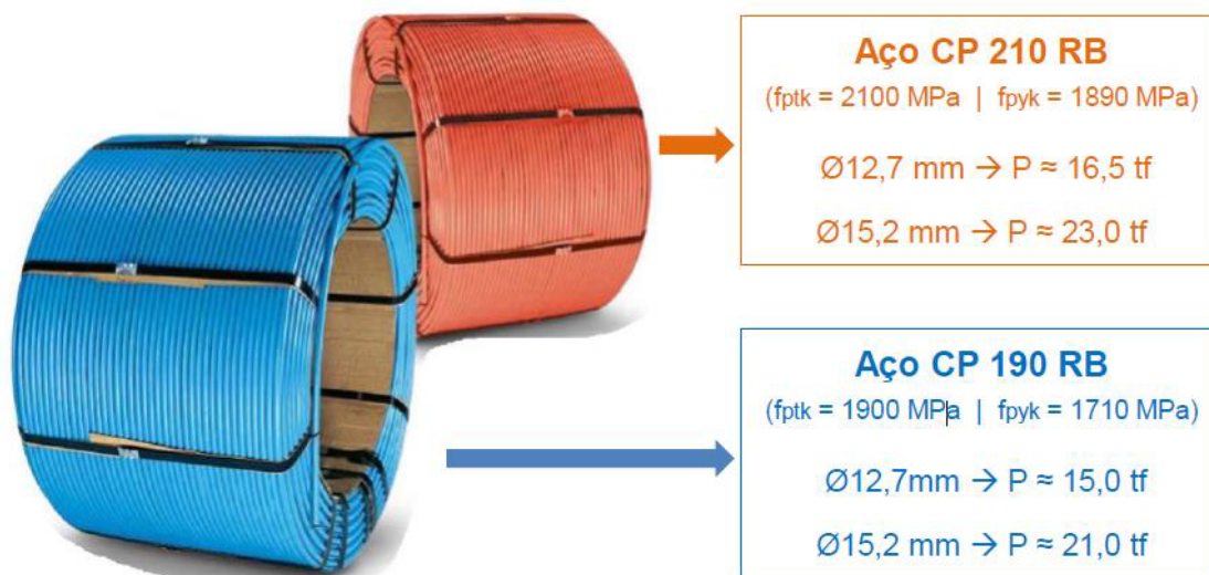
FIGURA 7 – Cordoalhas CP 190 e CP 210. Fonte: TQS (2021)
