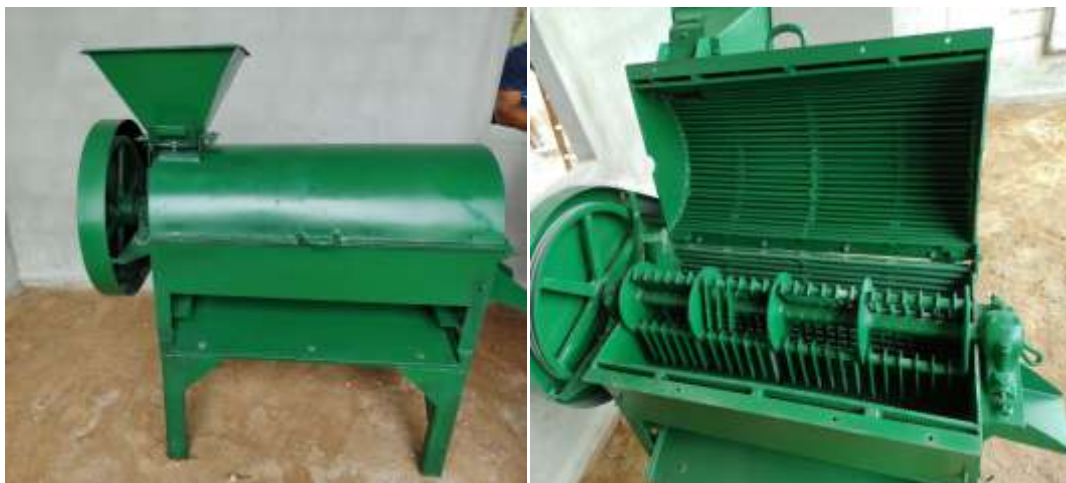
Figura 11 – Máquina despeladeira de licuri atual (fechada e aberta) com melhorias de PJ3
